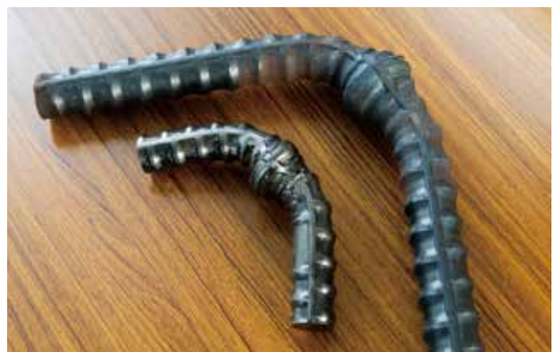
曲げ試験を終えた32mmの鉄筋（写真右上）。
